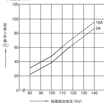
2. 一(2) 线圈温度上升 (1c DC型、1a DC型)
